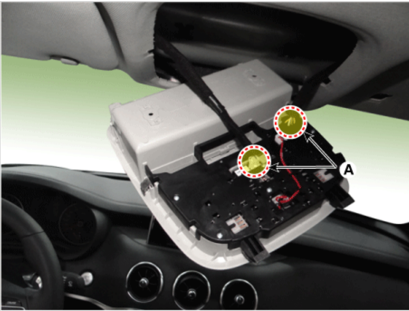
17. Separate the sunvisor cap (A).
